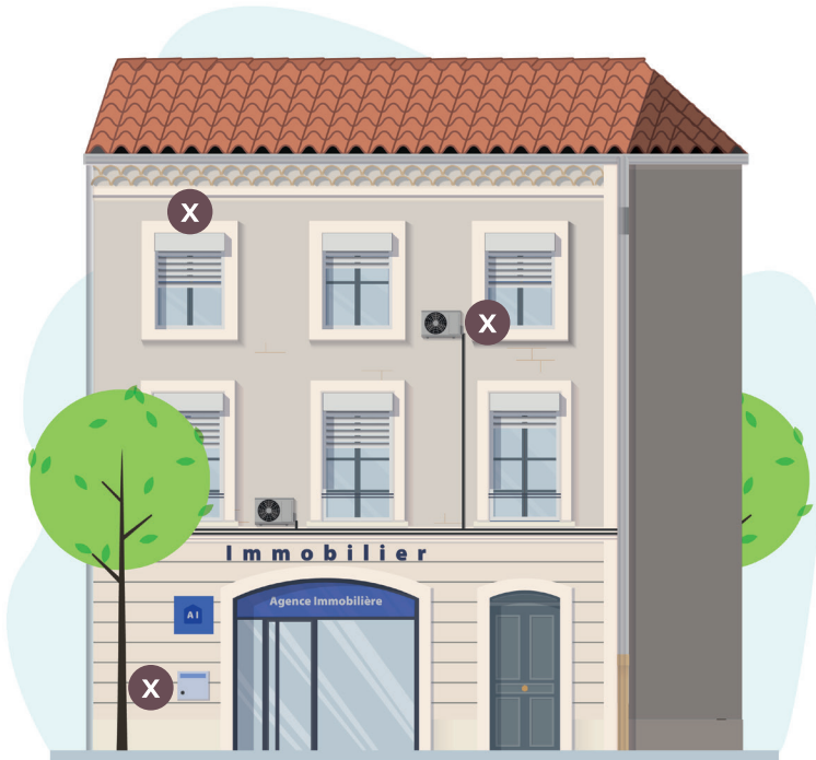
Une boîte aux lettres posée en saillie et l'évacuation d'un climatiseur débordant de la vitrine.
